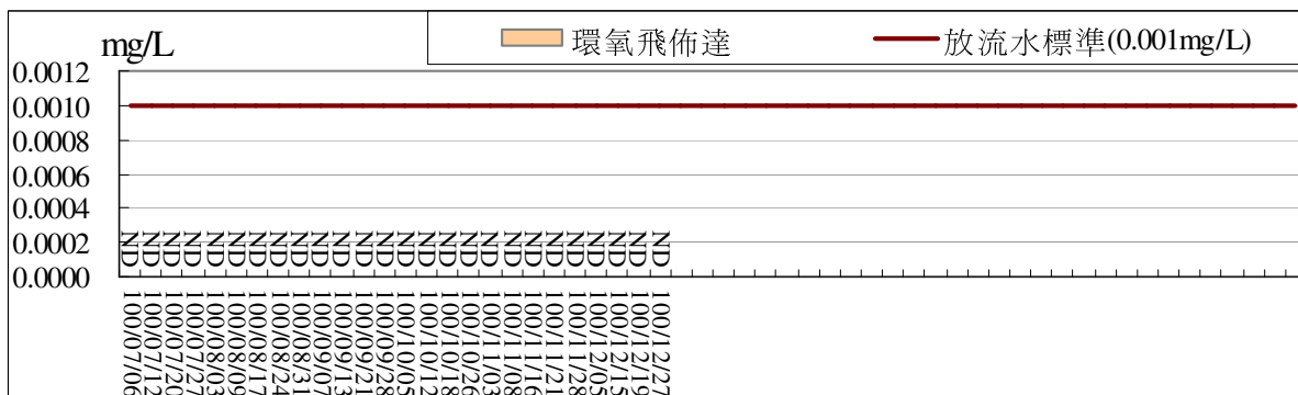
污水處理廠放流口放流水質監測結果比較圖(環氧飛佈達)
