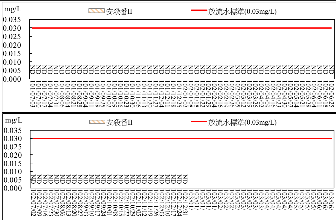
圖 2.50 污水處理廠放流口放流水質監測結果比較圖(安殺番 II)
