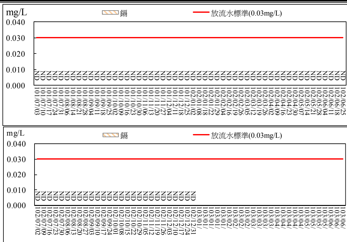
圖 2.40 污水處理廠放流口放流水質監測結果比較圖(鎘)
