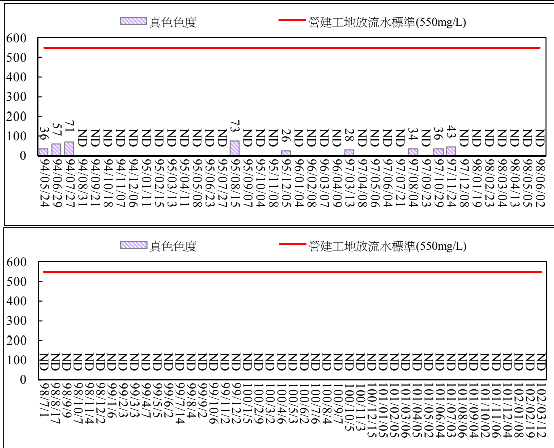
圖 2.85 工區放流口放流水質監測結果比較圖(真色色度)
