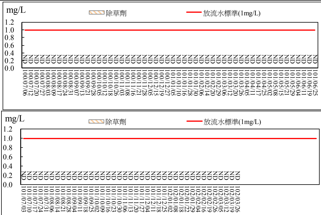
圖 2.56 污水處理廠放流口放流水質監測結果比較圖(除草劑)
