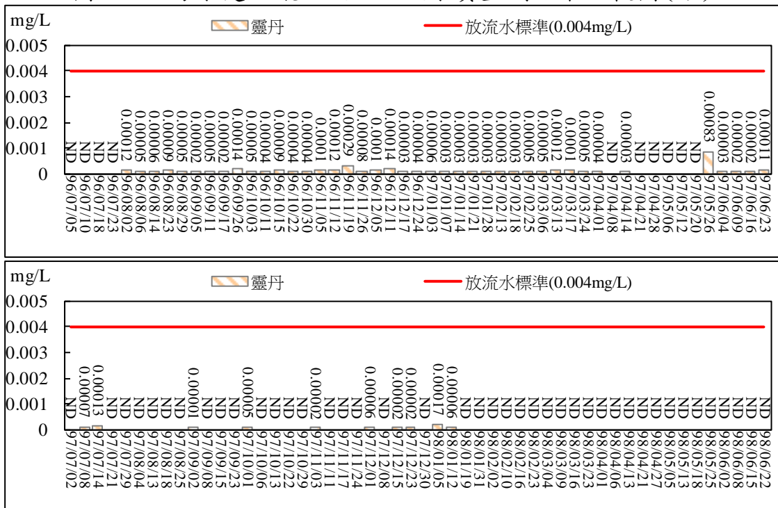
圖 2.47 污水處理廠放流口放流水質監測結果比較圖(銀)
