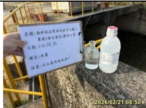
放流水水質檢測~污水廠放流口~樣品水色(115/02)
