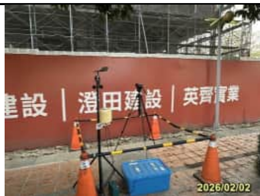
營建噪音檢測~工區周界外((115/02)
