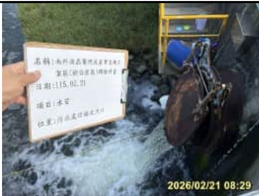
放流水水質檢測~污水廠放流口~採樣情形(115/02)
