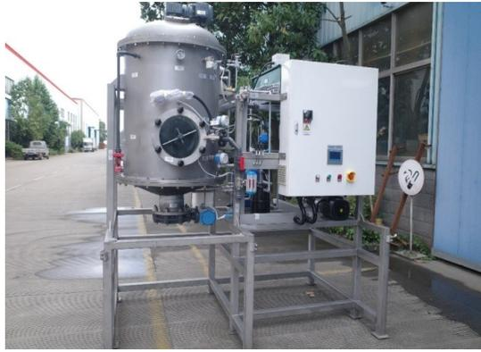
低溫真空蒸餾乾燥設備
